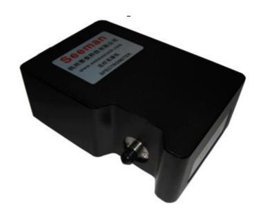
SY-VT100 微型光谱仪是是一款适合在照明检测领域的可见波段光谱仪,应用于 LED、节能灯的光谱特性测量。该光谱仪在数据采集卡和电脑之间的 USB 通讯加入了抗干扰芯片,具有稳定 USB 通讯稳定性,在强电磁环境下 USB 亦能正常工作,即使受到外界干扰,数据采集卡内置的 USB 恢复器,也能将 USB 通讯带回正轨,而不必插拔 USB 接口线,极大提高工作稳定性,从而保证仪器长时间连续工作。次光谱仪的数据采集卡的数据转换芯片摒弃了传统单纯的 AD 转换芯片,而里用 CCD 专用采样芯片,能在电源受到干扰产生波动的情况下,保持基线稳定,使采集得到的数据稳定可靠,一致性和重复性高。
