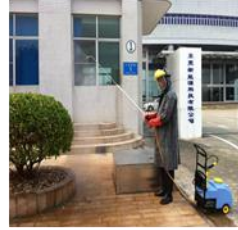
图片2 水雾灭火器 (穿着PPE防止触电)
