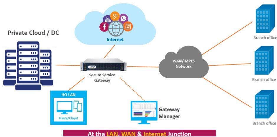
Allot 产品采用 Inline 或镜像方式部署在企业网数据中心出口，互联网出口，广域网出口处。
