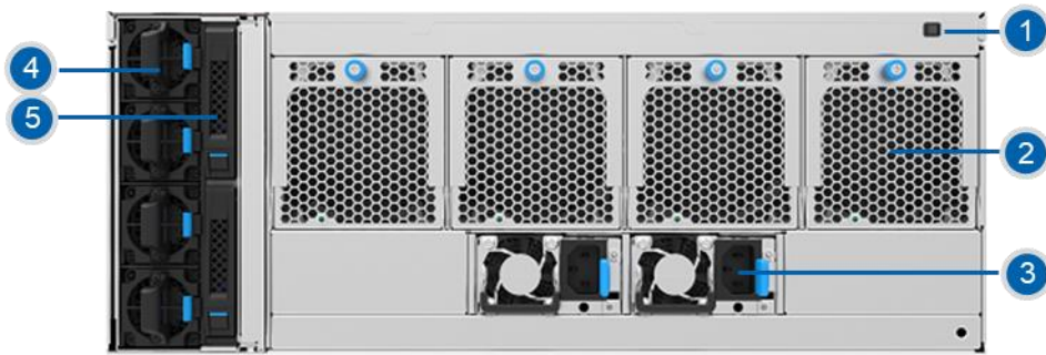
图 4-6 后面板正视图（控制器前置）
