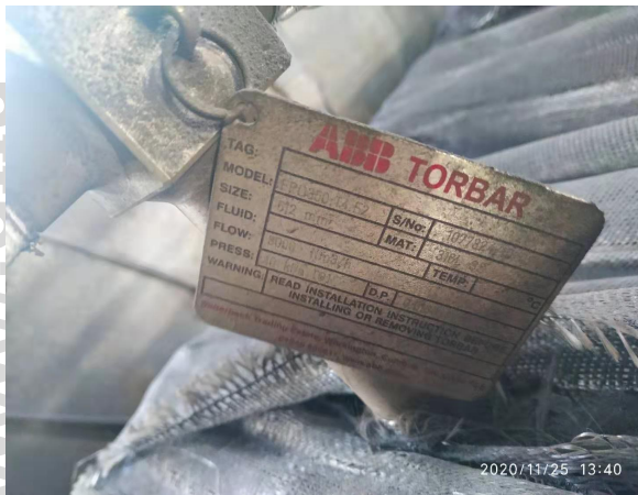
节流装置ABB 最大差压30PA
