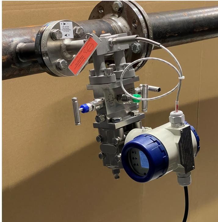
deltaflow DF25 für mit integriertem PT100, Kondensatvorlage, Dreiwegeblock und SYS-MMF in einer horizontalen DN100 Dampfleitung
