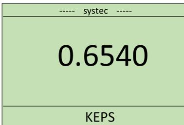
Der folgende Menüpunkt „Linear Gain“ ermöglicht eine lineare Durchflusskorrektur von 80% (0.80000) bis 120 % (1.20000). Damit können Sie Ihre Durchflussmessung z.B. nach einer Kalibrierung auf den korrekten Wert einstellen. Der vom SYS-MMF errechnete Durchflusswert wird mit dieser Konstante multipliziert.
