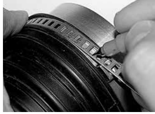
步骤 2 确定卡箍条带长度。
