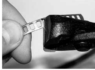
步骤 3 切断多余材料，将断面边缘挫平以防毛刺伤手。
