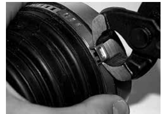
步骤 4 将卡箍置于工件，将挂钩挂上最紧的窗口位置，用欧梯克卡钳夹紧卡箍耳朵。
