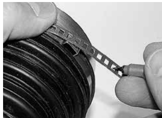
步骤 2 确定卡箍条带长度，保证卡箍的另一端绕过卡箍“耳朵”部位，如图所示。
