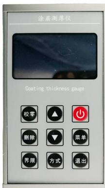
涂层测厚仪是一种经济实用型便携式测量仪，它能快速、无损伤、精密地进行涂、镀层厚度的测量。既可用于实验室，也可用于工程现场。通过使用不同的测头，还可满足多种测量的需要。本仪器能广泛地应用在制造业、金属加工业、化工业、商检等检测领域。是材料保护专业必备的仪器。涂层测厚仪使用了工程塑料外壳结构，更加轻便耐用，测值精准稳定，价格经济实惠！
