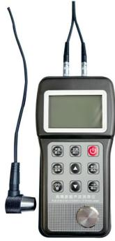
超声波测厚仪是根据超声波脉冲反射原理来进行厚度测量的，当探头发射的超声波脉冲通过被测物体到达材料分界面时，脉冲被反射回探头，通过精确测量超声波在材料中传播的时间来确定被测材料的厚度、被测量材质可以是以钢为代表的金属类材料，也可以是塑料、尼龙 等非金属材料超声波具有良好的指向性，超声技术测量金属，非金属材料的厚度，既快又准确，无污染，尤其是在只许可一个侧面可接触的场所，更能显示其优越性，广泛用于各管理起着主要的作用！
