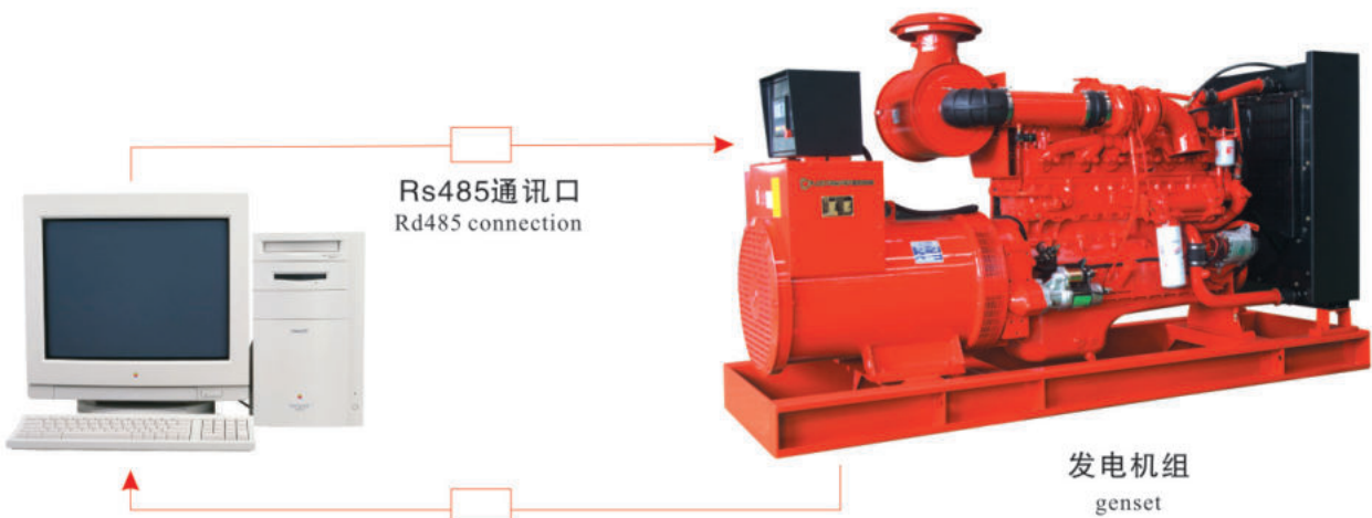
计算机直接连线控制（示意图） Computer direct on-line control(schematic drawing)
