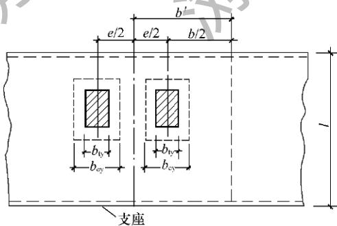
图 C. 0.5-3 相邻两个局部荷载的有效分布宽度
