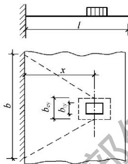
图 C. 0. 5-4 悬臂板上局部荷载的有效分布宽度
