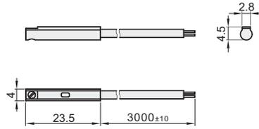
磁性开关安装槽尺寸
