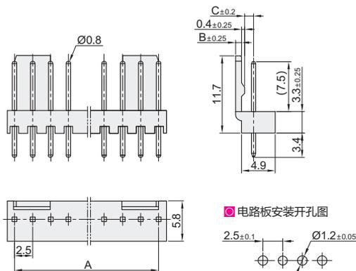
电路板安装开孔图
