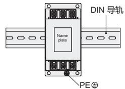
**!** 在DIN导轨上安装EMI滤波器
