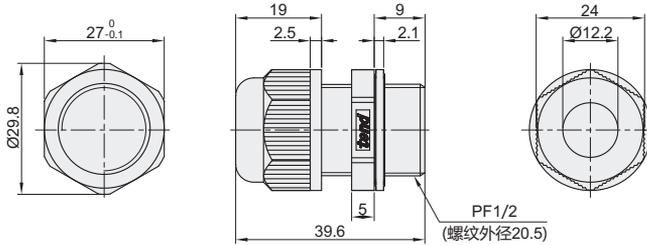
① 适用电缆外径: Ø6~12mm。
