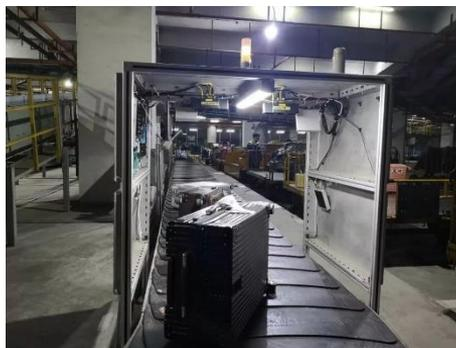
RFID/条码读取定制设备
