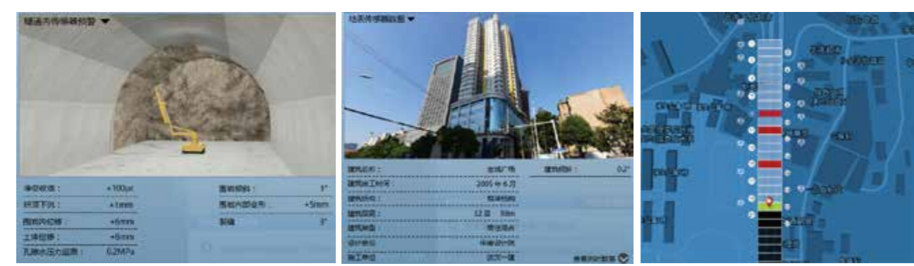
支护结构应力数据、隧底水压力数据、围岩变形数据 地表建筑倾斜监测 实现隧道衬砌厚度、空洞的自动检测自动识别衬砌裂缝、掉块、渗漏水等病害
