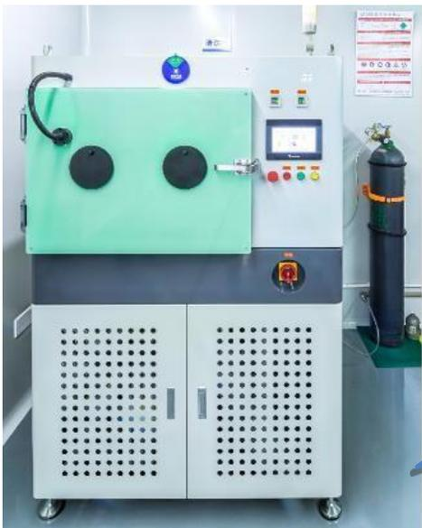
等离子清洗是利用Ar、H<sub>2</sub>、O<sub>2</sub>、N<sub>2</sub>气体的物理或化学作用，让表面微结构产生官能基或者粗糙度达到良好的结合性，采用真空电容式电极技术，产生高密度、高活性的电浆离子与自由基，将LED上的有机污染物，以物理和化学的方法有效去除，强化、活化表面的黏着力，保证产品的可靠度、稳定性更好。
