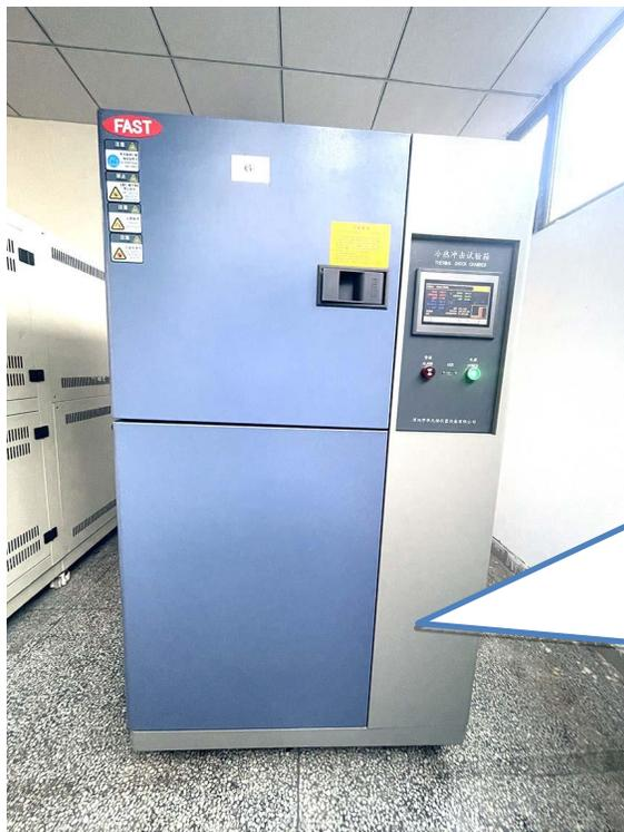
冷热冲击箱是一种极限检验产品可靠性的设备，最高温可以达到 +150°C，最低温度可以达到 -40°C，可根据产品的特性做破坏性实验，以验证产品在残酷环境下的可靠性。制程中IPQC定期进行巡检和抽检。
