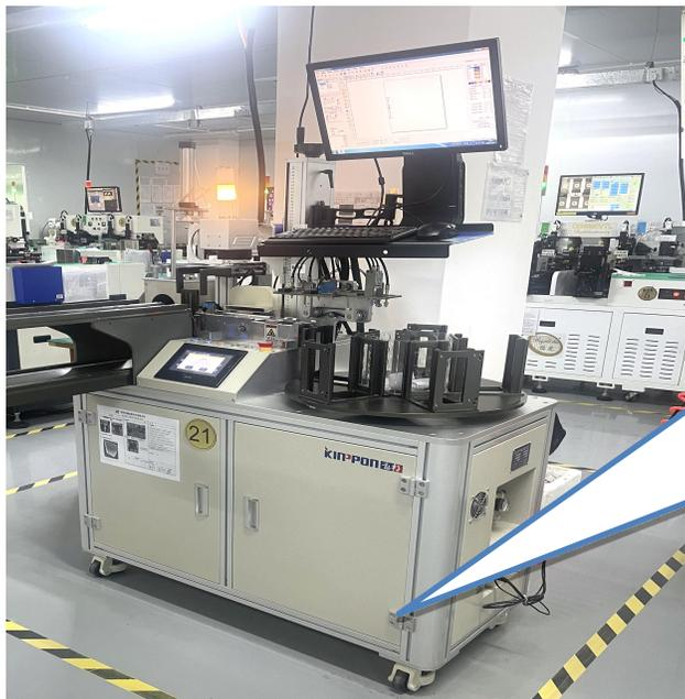
采用双轴运动平台，定位更精准；使用紫外激光器，字符最小达到0.1mm,精度±0.02mm，精断度更高；全自动工作，可对接各种MES系统。
