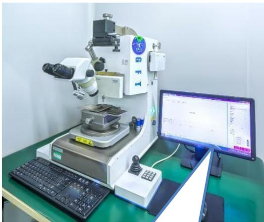
所有批次的产品都经过全自动推拉力测试机抽测金球的推力、线弧的拉力，符合要求后方可正常生产，制程中IPQC定期进行巡检和抽检
