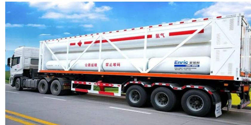
**高压氢气管束运输车 (载重40吨),
