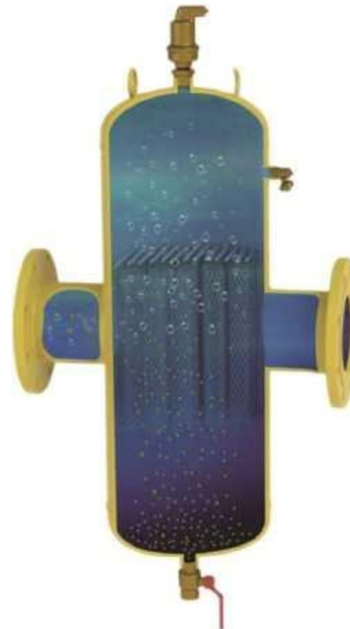
瑞恩瓦瑟微泡排气除污装置由于内部特殊的几何构造，能够彻底高效地清除系统中小到 $5\mu\text{m}$ 的颗粒杂质。
