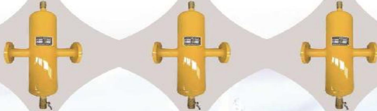
微泡排气除污装置采用先进的无网过滤技术，与传统过滤设备相比，由于没有滤网，在除气、除污过程中对管网产生的压降非常小，可将流体中10  $\mu\text{m}$ 以上气泡和5  $\mu\text{m}$ 至5 mm小颗粒杂质除去，防止形成的生物粘泥粘附在换热器表面造成的换热器堵塞、热计量表堵塞等情况，有效提高换热器换热效率，减少煤、天然气等燃料的使用，同时减少燃烧产生的废气、二氧化硫、烟尘、氮氧化物等废物的产生。手动排污阀设计，在排污时避免了大量失水的情况，自动排气阀可以排空管网中存在的空气，防止管网气蚀、生锈、老化，延长管网的使用寿命。
