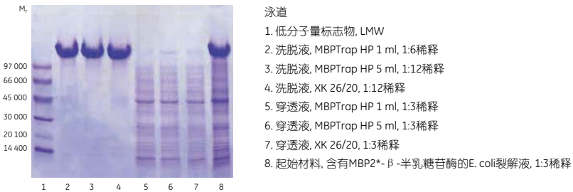
图6.8 SDS-PAGE分析 (还原状态) 进行规模放大研究。
