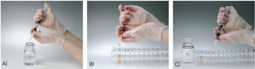
图57：用注射器来操作GSTrap。（A）准备缓冲液和样品。除掉柱子的顶盖，掰掉底部封口。（B）将样品上柱并收集组分。（C）洗涤和洗脱，继续收集组分。
