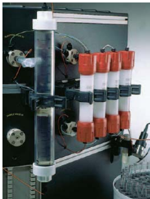
图92： 60ml样品可以在四个串联的HiPrep 26/10脱盐柱中运行。
