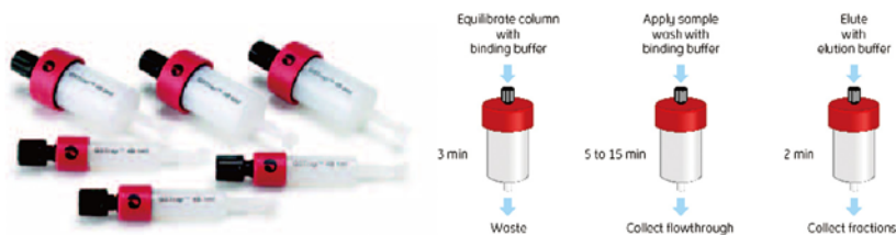
图55: GSTrap HP, GSTrap FF和GSTrap 4B 1ml和5ml柱子可以简单方便的一步纯化GST标签蛋白。GST标签蛋白的简单纯化在右侧显示。
