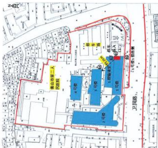
图2 室外现场辐射剂量率检测布点图
