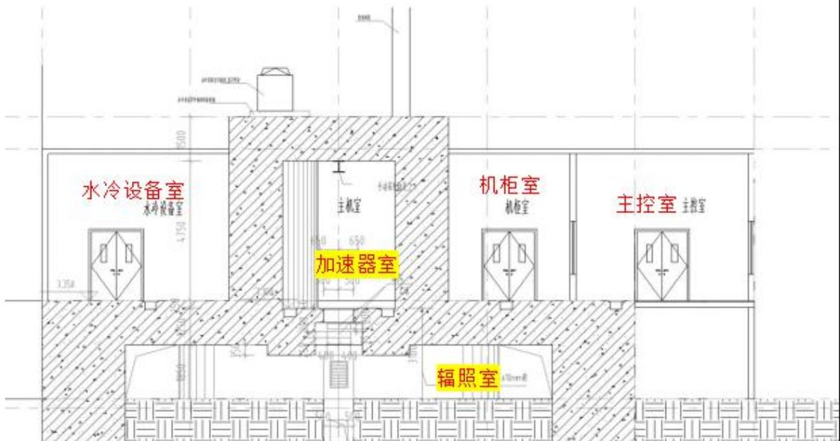
图 9-3 加速器辐照室设计方案剖面图
