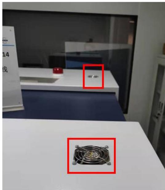
图 10-6 三维 X 射线显微镜换气风孔示意图
