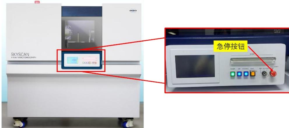
图 10-5 三维 X 射线显微镜急停按钮示意图
