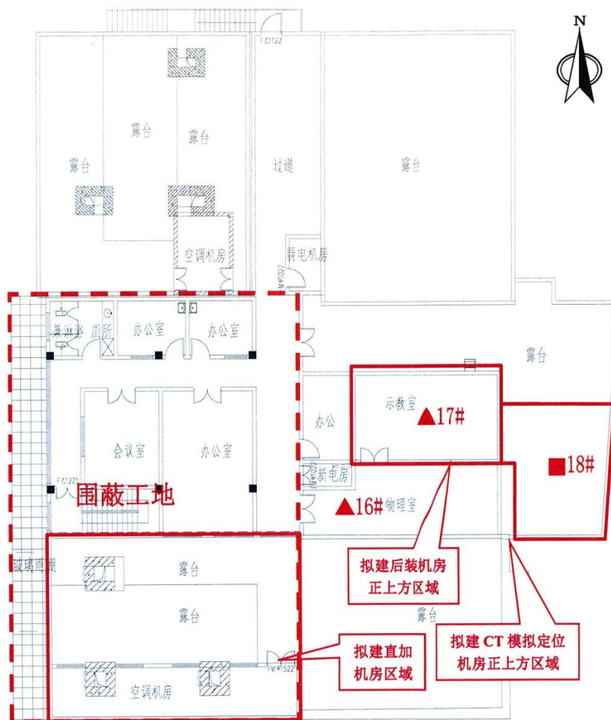
图2 放疗大楼二层 \gamma 辐射空气吸收剂量率监测点位示意图
