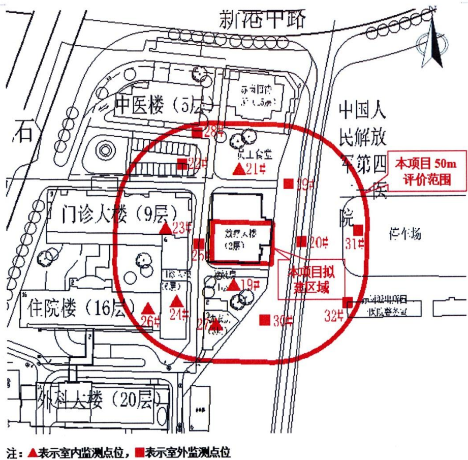
图3 项目 50m 评价范围内 \gamma 辐射空气吸收剂量率监测点位示意图
