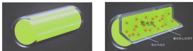
图 9-1 氚气管构造图
