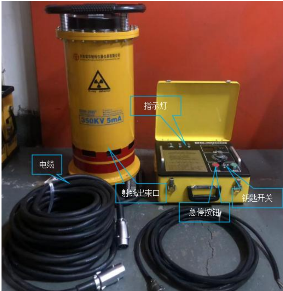
图 9-2 XXGHZ3505 型便携式 X 射线探伤机组成示意图（图片厂家提供）
