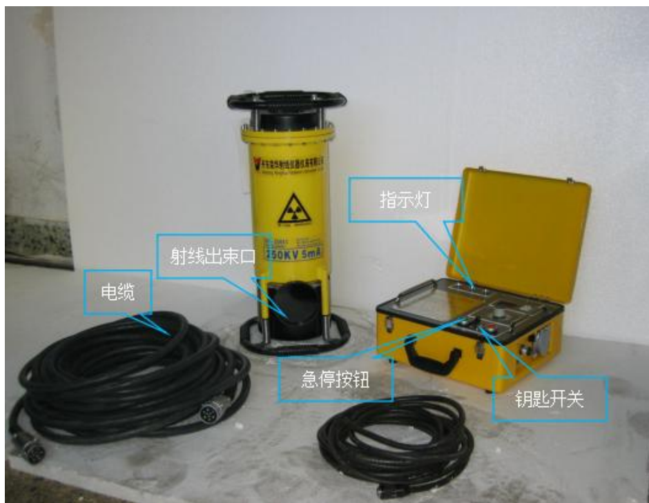
图 9-3 XXG2505 型便携式 X 射线探伤机组成示意图（图片厂家提供）
