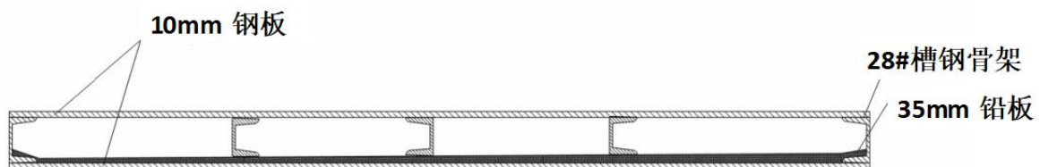
图 10-3 探伤室屏蔽体结构示意图
