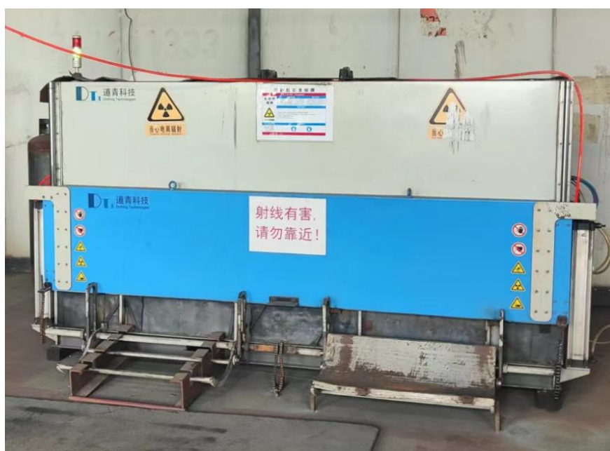
图10-12 DU201型X射线数字成像检测系统警示标识、指示灯现状图
