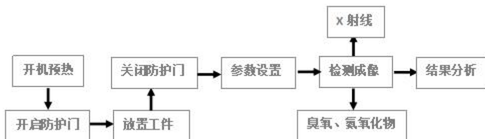
图 9-7 XR225-D 型 X 射线检测系统工艺流程及产污环节
