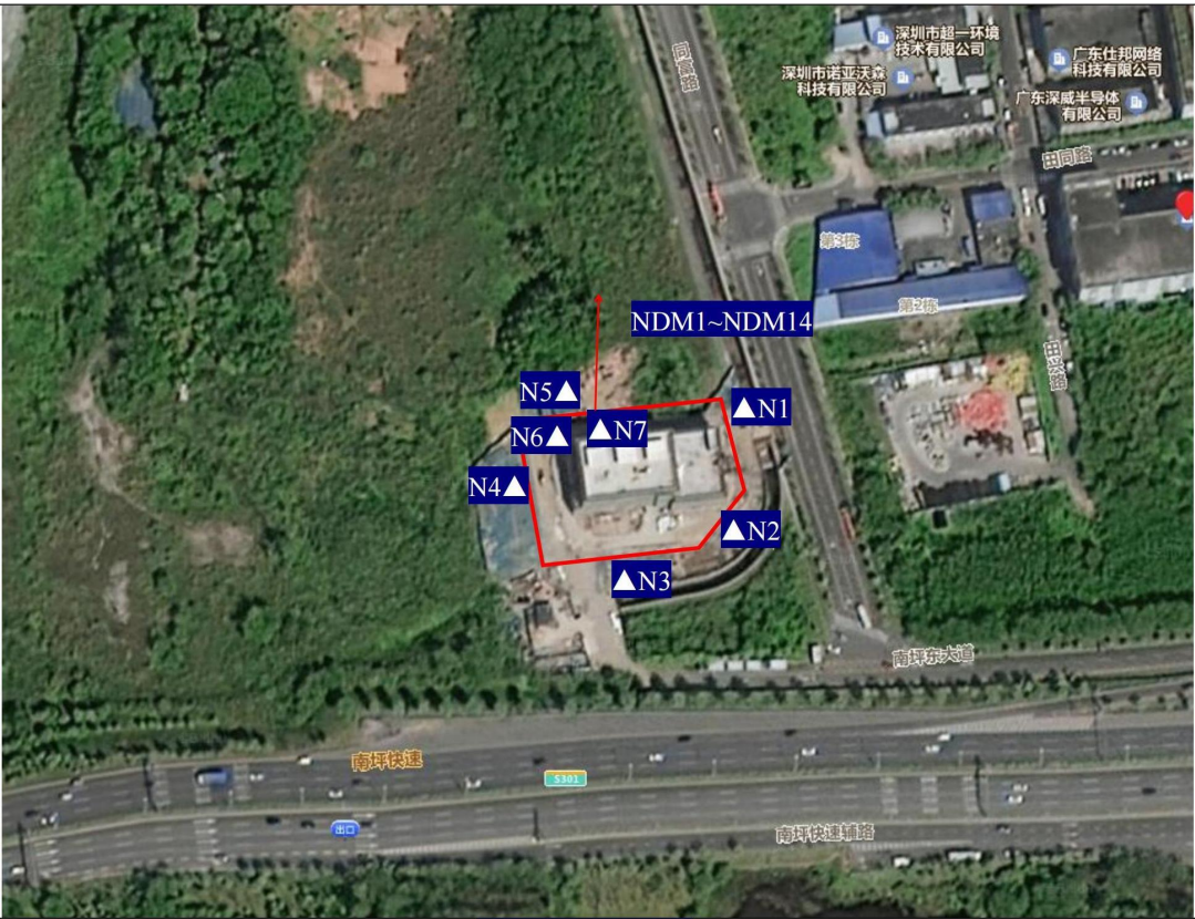
图4-3 110kV友谊变电站监测布点图
