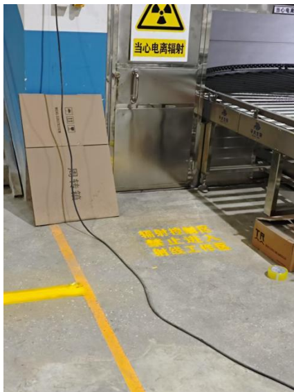
图 3-17 机房二层主机室监督区控制区划分图（黄色监督区，红色控制区）
