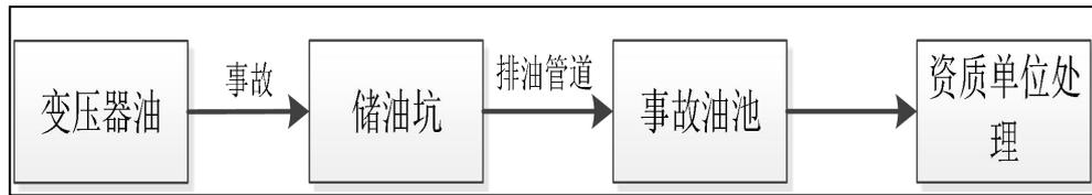
图 6 事故油处理流程
