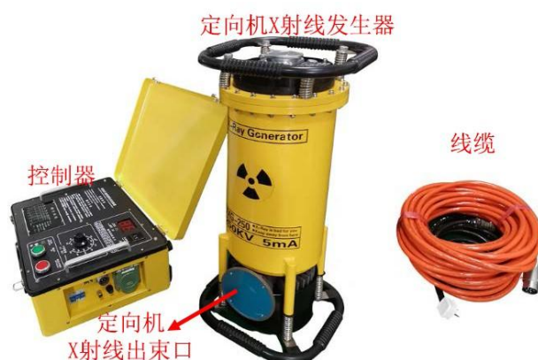
图 2-4 X 射线探伤机示意图
