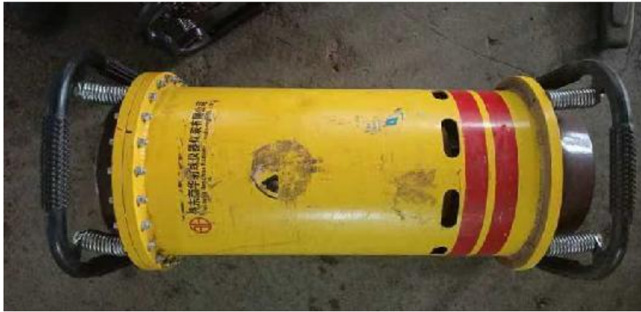
图 9-3 XXGHZ-3505 型便携式周向 X 射线探伤机组成示意图（周向机）
