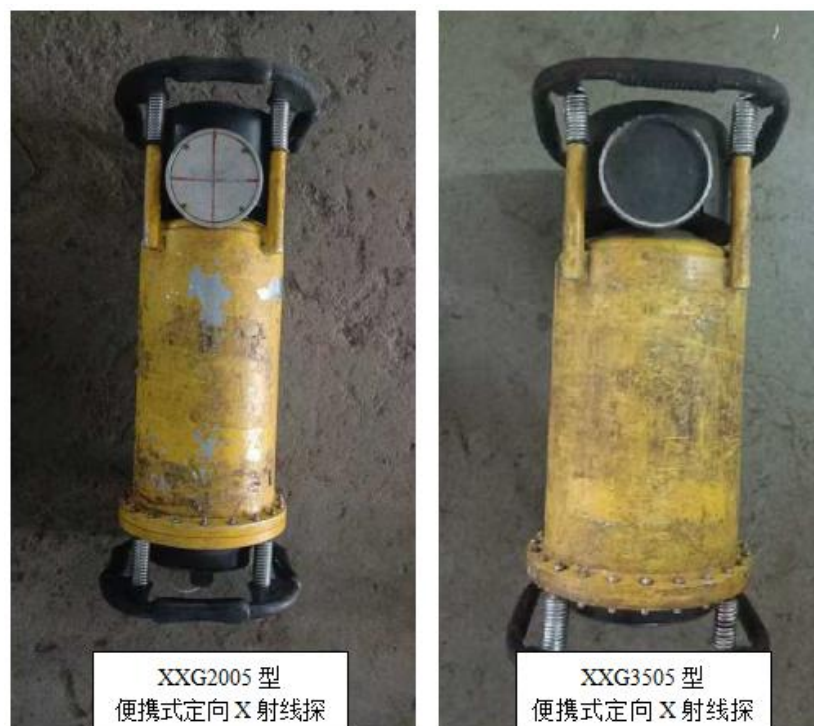
图 9-2 XXG2005 型和 XXG3505 型便携式定向 X 射线探伤机示意图（定向机）
