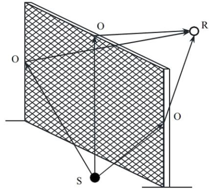
图 4 (1) 无限长声屏障示意图
