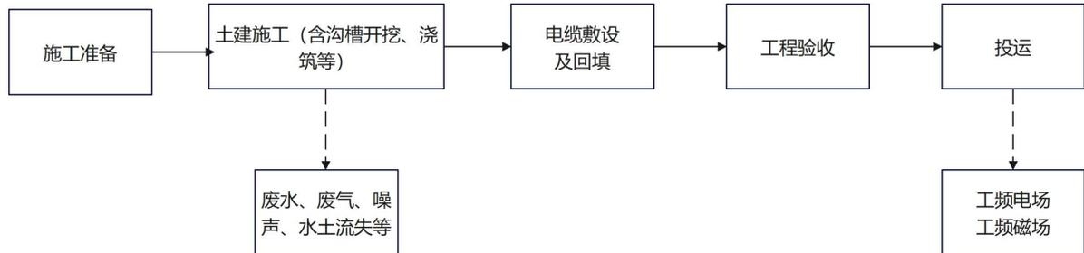
图 2 电缆线路施工工序流程及产污示意图
