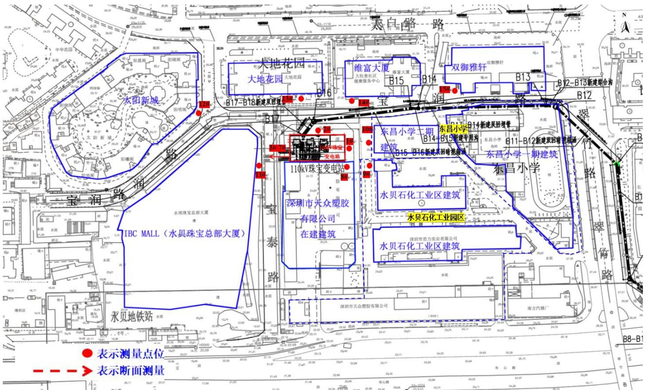
图 8 变电站类比监测布点示意图
