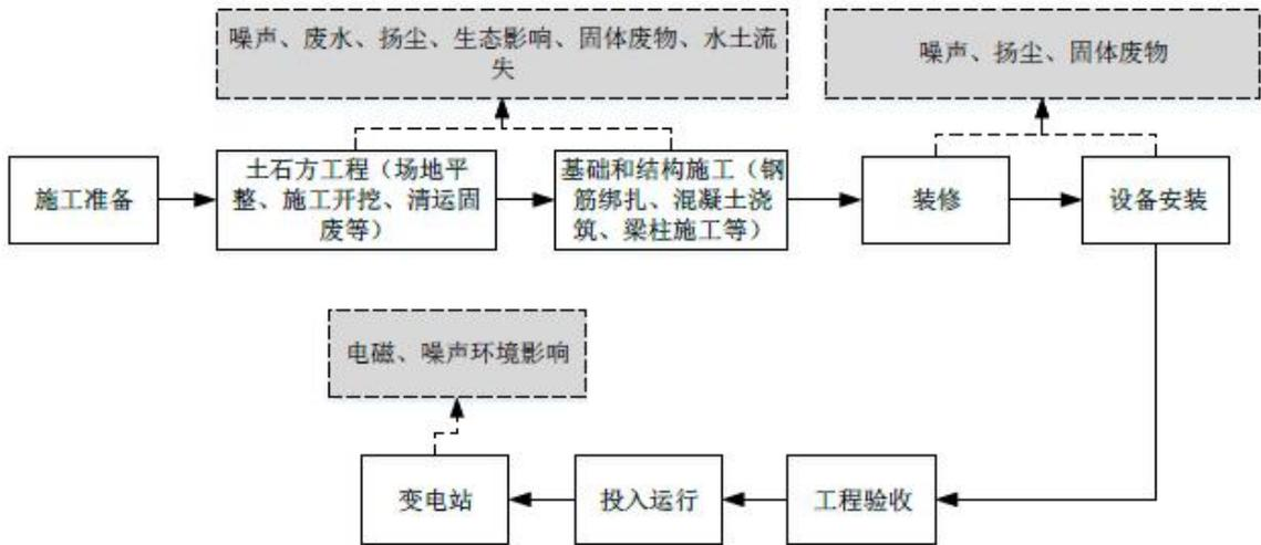
图 1 变电站工程工艺流程及产污环节
