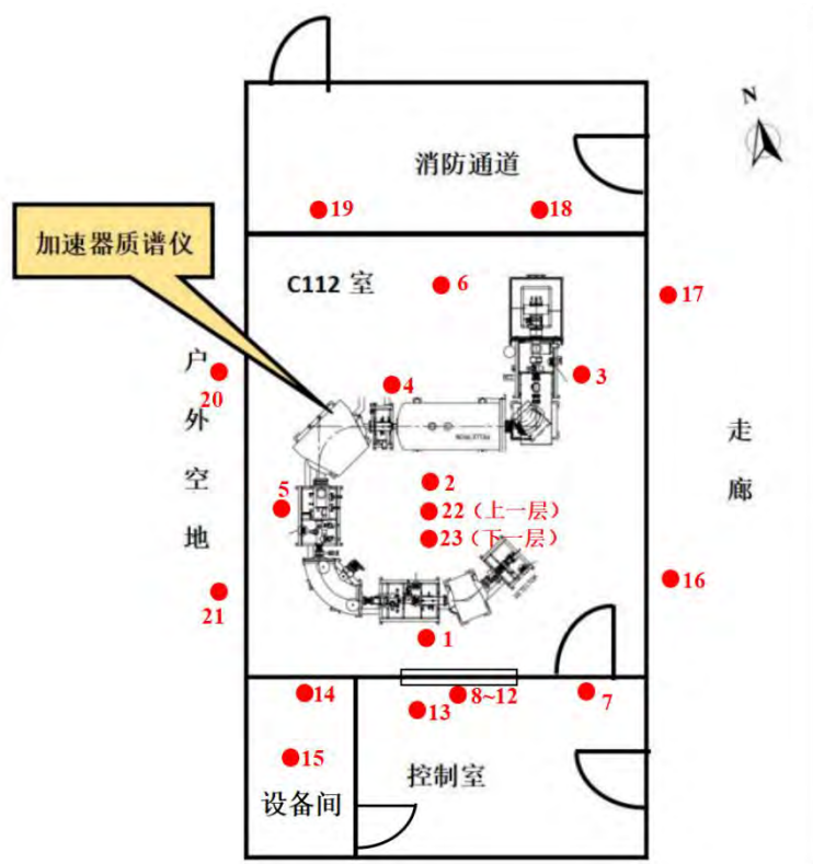
图 6-1 GeoScan200 型加速器质谱仪周围剂量当量率布点示意图
