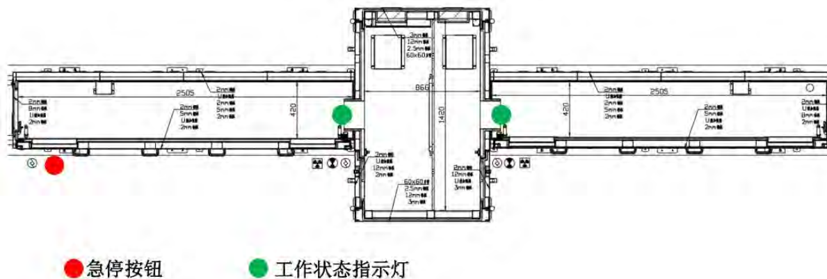
图 3-7 岩芯 CT 扫描仪的急停按钮和工作状态指示灯安装位置示意图
