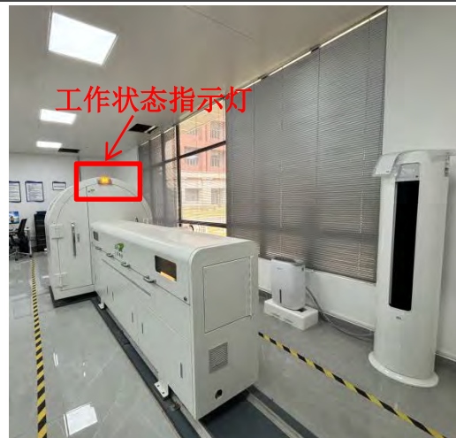
图 3-8 岩芯 CT 扫描仪的急停按钮和工作状态指示灯现场安装位置示意图
