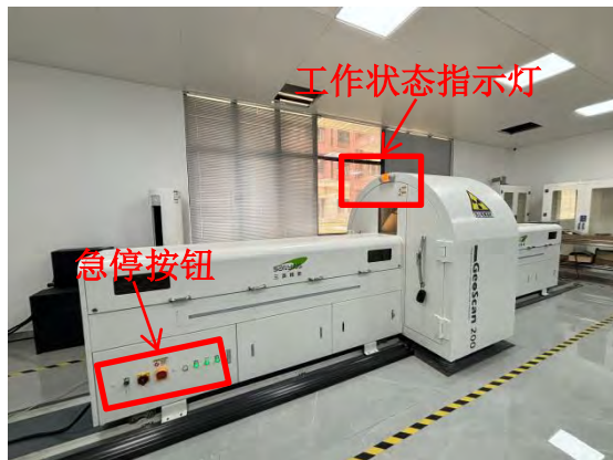
图 3-8 岩芯 CT 扫描仪的急停按钮和工作状态指示灯现场安装位置示意图
