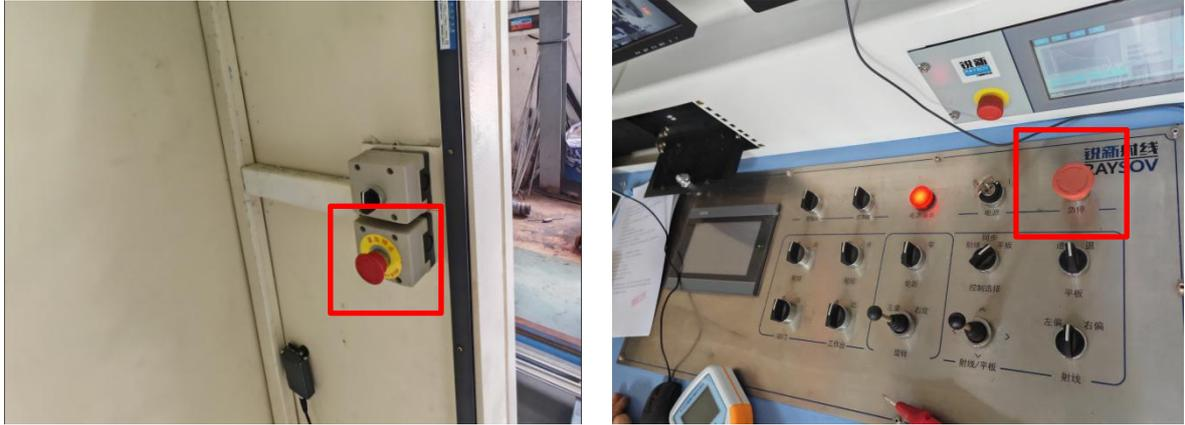
图 3.3-2 急停装置现场照片
