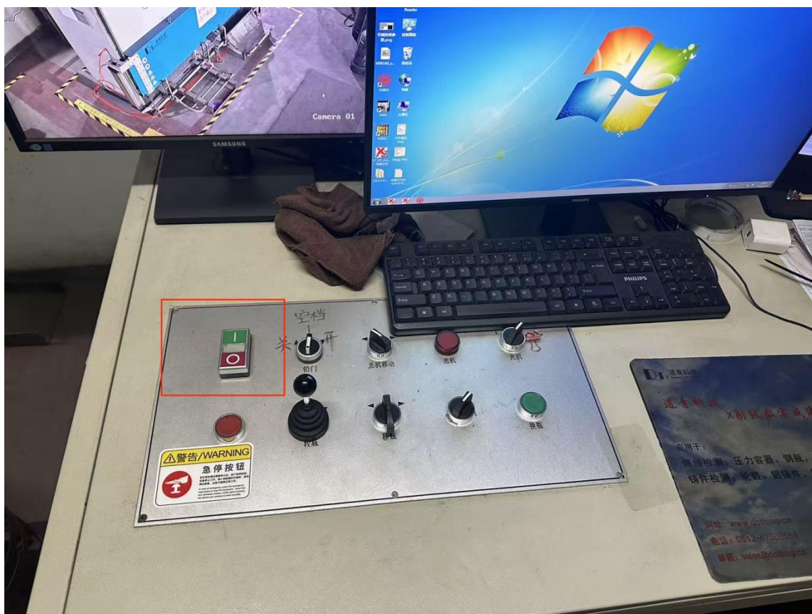
图 3-3 DU201 型 X 射线数字成像检测系统急停装置
