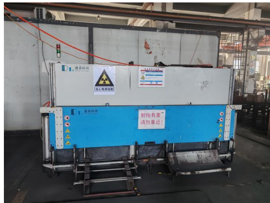
图 3-2 DU201 型 X 射线数字成像检测系统辐射安全警示设施
