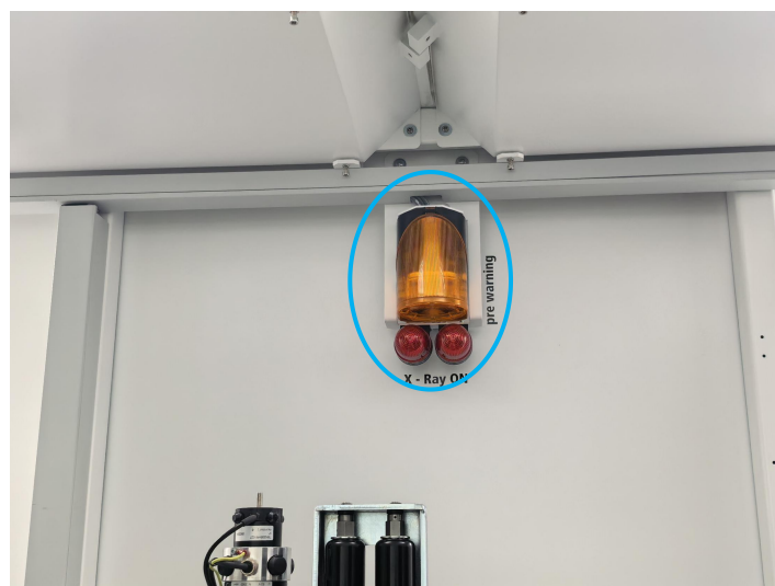
图 3-7 工业 CT 内部工作状态指示灯 (篮圈为工作状态指示灯)
