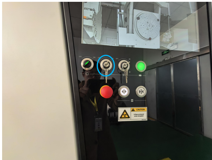
图 3-5 工业 CT 钥匙开关实物图（蓝圈为钥匙开关）
