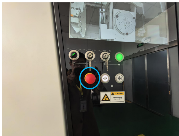
图 3-9 工业 CT 外部急停按钮（蓝圈为急停按钮）
