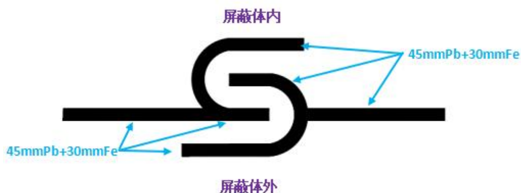
图 3-6 电子加速器辐照装置的控制线缆穿过屏蔽体图
