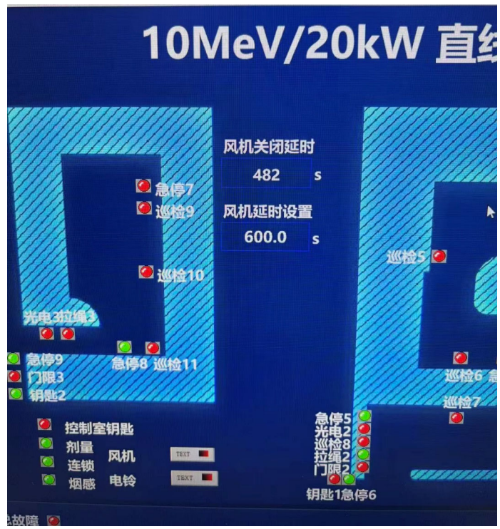
图3-13 加速器机房通风连锁
