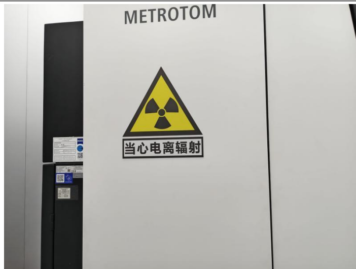
图 3-11 工业 CT 的电离辐射标识
