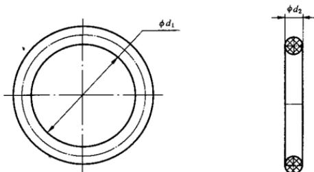
图 1 典型的 O 形圈结构
