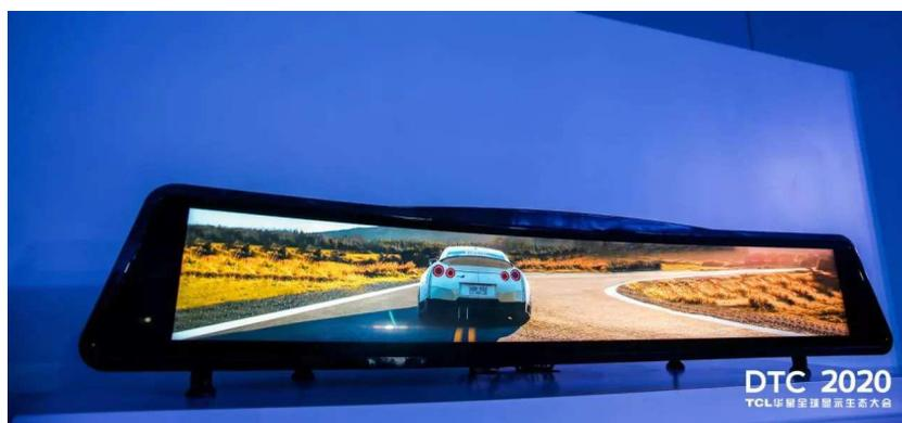
图 3.4-6 48' mini-LED 车载曲面屏
