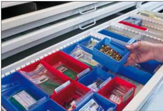
为了避免静电放电带来的破坏，电子设备及元件的处理、包装和存放必须在 ESD 保护环境中进行。为此，我们为特定需求的用户在工业回转库上提供导电工作台，为多功能料斗提供抗静电涂层和特殊 ESD 设计的机械系统。
