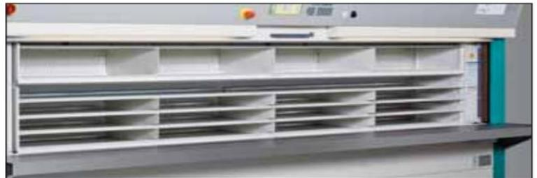
具有水平存放隔板并在每层配置移动、分隔件的多功能料斗
