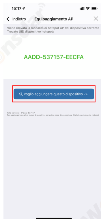
L'APP mostrerà l'UID della videocamera, fare clic su "Sì, voglio aggiungere questo dispositivo"
