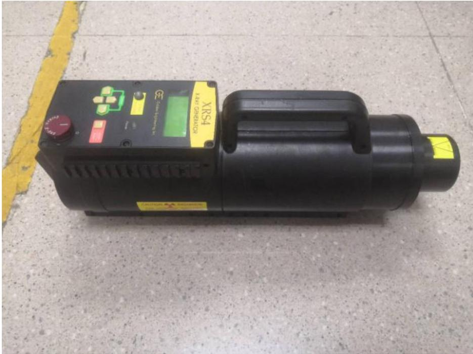
图 9-8 Golden XRS-4 型探伤机（脉冲式）
